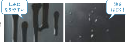
とれちやうコート非採用機種(当社2010年度モデル) ER-HD500 とれちやうコート ※庫内壁面にサラダ油を附着して比較。
