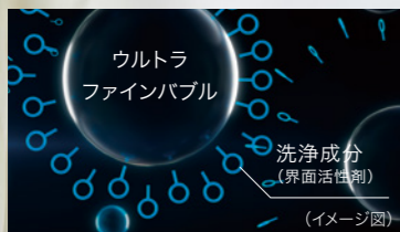
ウルトラファインバブルが洗剤の洗浄成分を吸着
