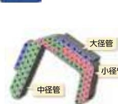
3種の異径管を組み合わせて大型化を回避しながら管内熱伝達係数を改善
