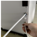
18. Tháo ống nhựa PE từ ngõ vào nước máy.
