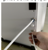
18. Tháo ống nhựa PE từ ngõ vào nước máy.
