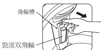
\* 若因棉絮卡住而難以拆開勁流雙飛輪，可用水浸濕並用刷子軟化棉絮。
