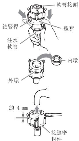
5 取出接頭內的密封墊，朝箭頭方向轉動，鎖緊接口。
