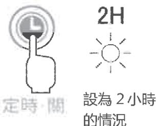
在設備運行時，觸摸關機計時器按鈕，則可設置定時關機功能，觸摸按鈕時設定時間會發生變化。與設定時間對應的指示燈亮燈則設定完成。
