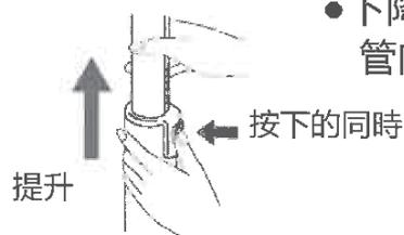
●下降時，將滑動套管向下推入。
