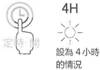
在設備運行前，觸摸開機計時器按鈕進行設置，每次觸摸時設定時間都會發生變化。與設定時間對應的指示燈亮燈則設定完成。
