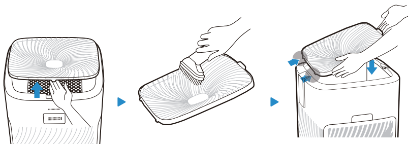
出風口格柵 打開出風口格柵，用吸塵器清理灰塵，用布擦拭。
