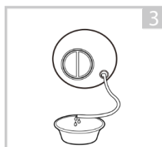
待水流出後，裝回排水管。
