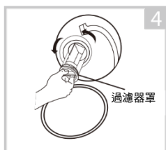
按逆時針方向轉動，打開過濾器罩
